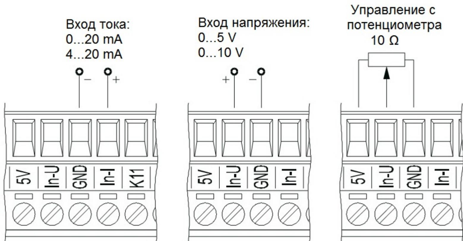
Рис.5. Подключение управляющих сигналов
